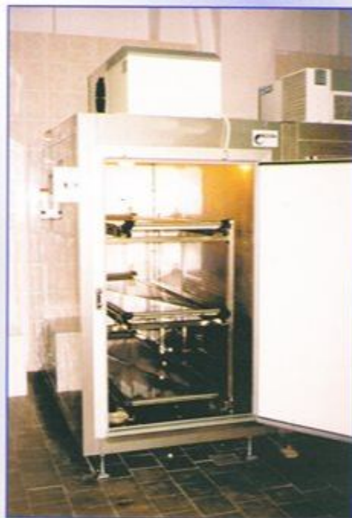
ROK 2001 KOMORA MROŹNICZA (-20 C) NA 3 CIAŁA NA TACACH - ZAKŁAD USŁUG KOMUNALNYCH SZCZECIN
